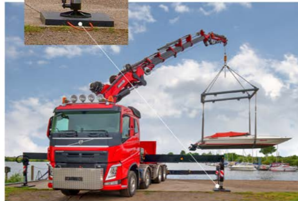
So sind die Abstützungen sicher unterbaut – nämlich mittig platziert.
