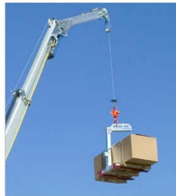
Palettengabel als formschlüssiges Lastaufnahmemittel
